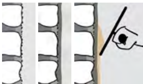
L'enduit chaux en 3 passes, gobettis, corps d'enduit et finition talochée.
