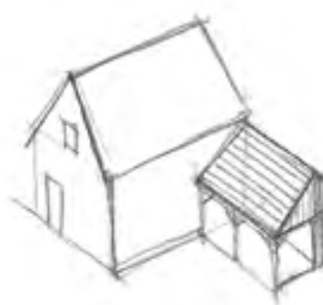
Abri léger orthogonal au bâti principal
